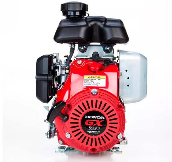
Motor de 3 hp, sistema OHV (válvulas a la cabeza) de eje horizontal, con arranque manual. Los profesionales basan la elección de este motor para ofrecer en sus productos un arranque fácil y seguro, y un bajo consumo de combustible. Este motor ha sido desarrollado por Honda para ser utilizado especialmente en vibro piones.
