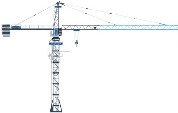
La estructura de acero con larga vida útil y alta seguridad. La grúa torre Flat-Top está diseñada sin varilla de tracción para reducir la altura de la parte superior de la torre y cumplir con los requisitos en diferentes sitios de trabajo. Especialmente adecuado para el desmontaje y montaje en obras de construcción restringidas o durante la operación transversal de varias torres.
