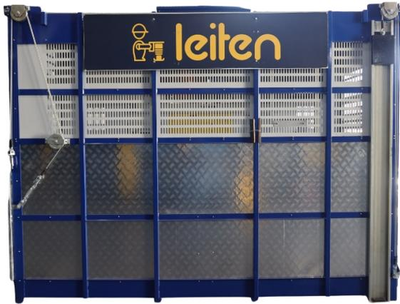
Sistema de transporte vertical con cabina doble confiable y eficiente, diseñado para un acceso seguro a diferentes niveles de un edificio en construcción. Su altura de elevación es de 50 metros y soporta 4000 kilos de peso en total. Capacidad para 48 personas. Velocidad de elevación de 0-46 m/min, con variador tanto en ascenso como en descenso. Altura máxima de instalación de 600 metros.
