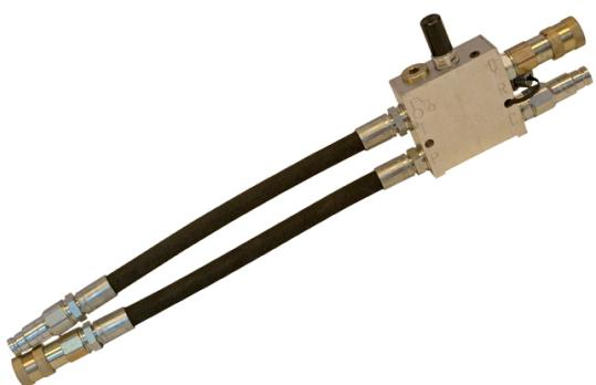
El divisor de flujo de aceite HYCON HFD reemplaza la necesidad de paquetes de energía y es perfecto para conducir todas las herramientas HYCON en los lugares de trabajo donde ya existe una máquina hidráulica como una retroexcavadora, un skidsteer o una miniexcavadora. El HYCON HFD tiene 3 funciones integradas: • Control de flujo de salida de aceite por la válvula de regulación de flujo integrada.
