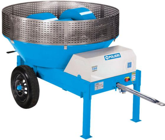
Ideal para la producción de molienda fina, yeso, trituración de inerte de origen volcánico. Equipada con un equipo de transmisión con engranajes engrasados que aseguran alta confiabilidad y máximo silencio. El bastidor es de acero fuertemente dimensionado. El Tanque es de chapa de acero con el fondo de gran espesor y el borde conformado.
