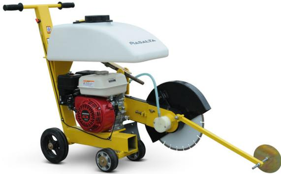
La cortadora de asfalto MFS14 es una versión modificada de nuestra conocida serie MF14. La máquina tiene un sistema de corte giratorio que evita de forma inteligente que el motor se desplace durante la operación de corte. La profundidad de corte máxima es de 185mm y se puede alcanzar con el disco -Ø 350 mm. Un depósito transparente y grande de agua permite una operación continua y prolongada.
